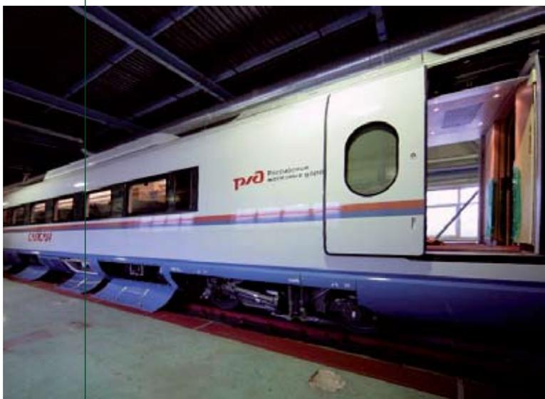
Остов кузова вагона представляет собой цельнонесущую сварную облегченную алюминиевую монококовую конструкцию. Он изготовлен из крупногабаритных прессованных профилей.
