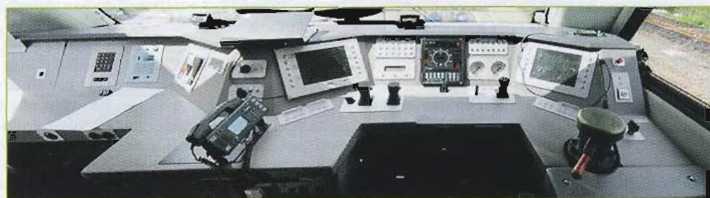
Рис. 6. Пульт управления электропоезда
