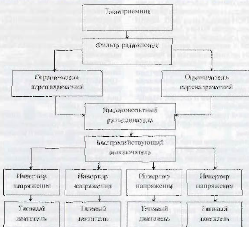
Рис. 11. Принципиальная силовая схема моторного вагона электропоезда
