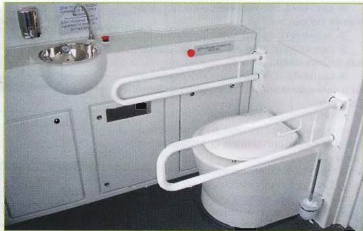
Рис. 13. Санитарный блок, приспособленный для пассажиров с ограниченными физическими возможностями
