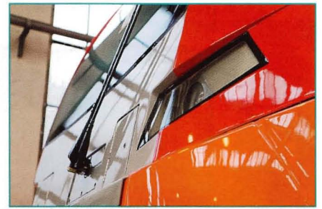
Рис. 5. Маска кабины машиниста электропоезда «Desiro Rus» и ее лобовая часть
