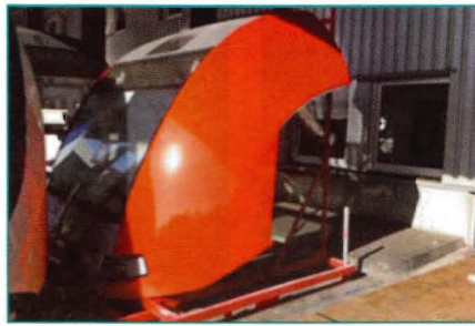
Рис. 5. Маска кабины машиниста электропоезда «Desiro Rus» и ее лобовая часть
