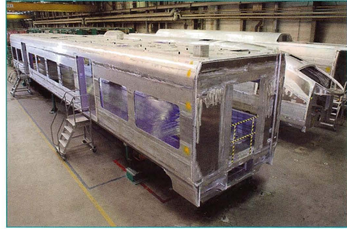
Рис. 3. Кузов головного вагона с крэш-элементом электропоезда «Desiro Rus» и его производство
