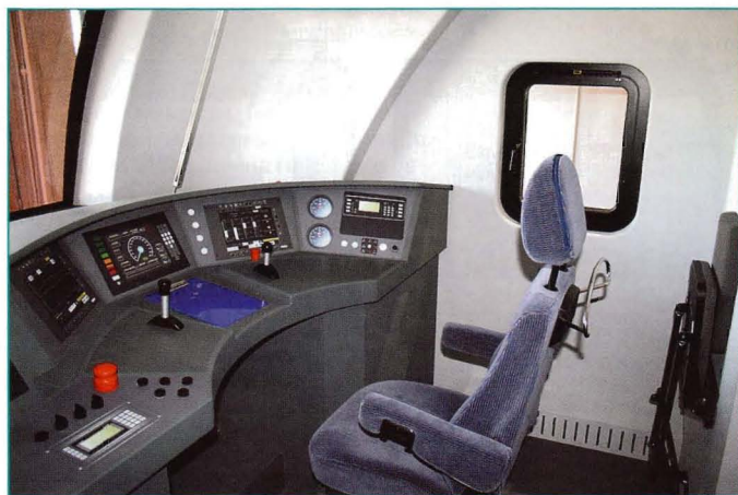
Рис. 10. Пульт управления электропоезда «Desiro Rus»
