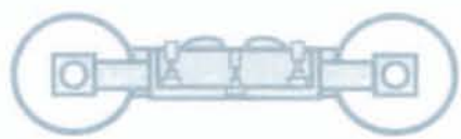
Немоторные тележки. Три тормозных диска на оси на колесную пару
