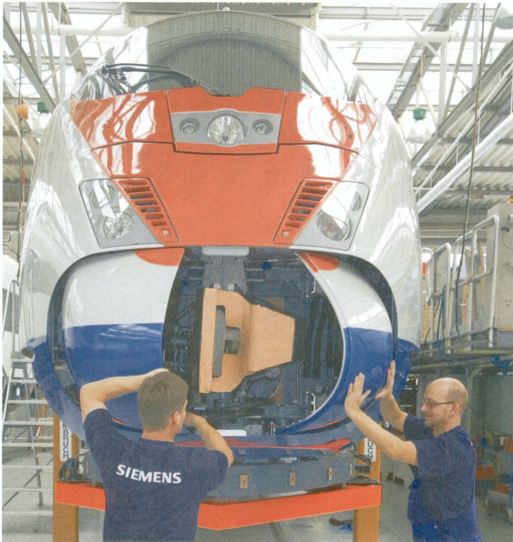
Поезд «Сапсан» перед отправкой с завода «Сименс» в Крефельде. В головной вагон интегрирован российский узел сцепления.
